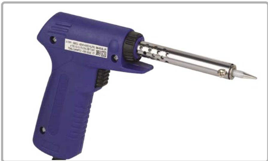
● Паяльник пистолетного типа с разными режимами мощности 25/80 Вт незаменим при пайки медных проводников и ручного монтажа радиоэлементов. Максимальная мощность и ускоренный разогрев активируются нажатием кнопки на корпусе.
